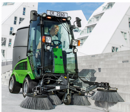
Sop-/sugsystem med 3. och 4. sidoborstar
