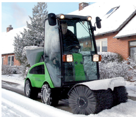
Sop-/sugsystem med 3. och 4. sidoborstar
